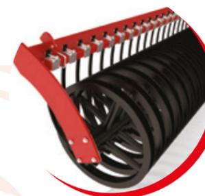
Conseillé en particulier sur sol avec une tendance à motter. La section de grattoirs soutenue par les anneaux, garantit le bon morcellement des mottes. La construction du rouleau pétrie le sol par bande et crée de meilleures conditions pour l'humidité du sol.
