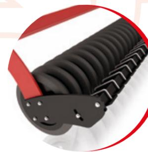
Rouleau constitué de disques en caoutchouc Ø 500 mm. Peut être utilisé en conditions de sol humide ou sec. Les propriétés du caoutchouc des disques et des grattoirs du rouleau, permettent d'éliminer le colmatage du rouleau. Grâce au diamètre optimal et à sa facilité de rotation, il n'y a pas d'effet "raclage" du sol, mêmes à faible vitesse de travail.
