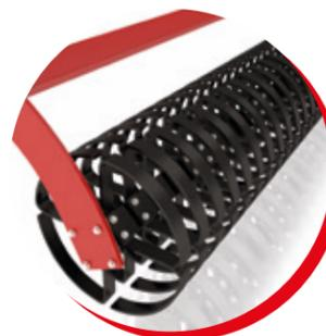
Composé d'anneaux souples en acier trempé. Ce rouleau est destiné à la préparation des sols lourds, il renforce le sol en brisant les mottes et en créant de meilleures conditions pour l'humidité du sol. Il est anti-colmatage et anti collage sur sol mouillé. Les grattoirs émettent les mottes passant entre les anneaux. La surface lisse des anneaux évite le collage sur le rouleau, mêmes sur des sols humides et argileux.
