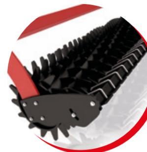
Rouleau à dents plein, Ø 500 mm ou 600 mm. Idéal pour les sols humides, pierreux et riches en matière organique. Ce rouleau garantit une densité homogène moyenne de la couche supérieure du sol sur toute la largeur de la bande cultivée. Une section de grattoirs nettoient le rouleau sur sol humide. Peut également être utilisé sur les sols moyens et lourds. Les grattoirs sont en acier trempé.
