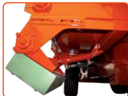
Calamita allo scarico con sollevamento idraulico (a richiesta)
