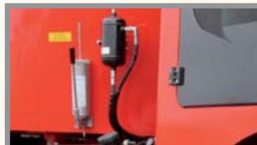
Graissage centralisé manuel ou automatique.
