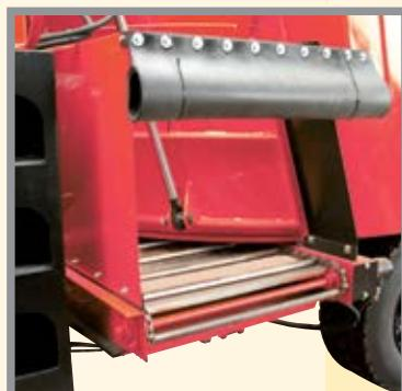
Tapis de déchargement avec chaînes et lattes en inox OU avec tapis en PVC.
