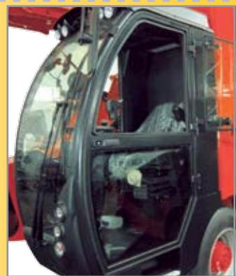
La cabine est montée à l'avant-gauche sur silent-blocs pour plus de confort.
