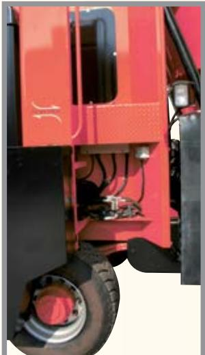
**Escalier et plateforme d'inspection:** accès aux installations électrique et hydraulique par l'ouverture de l'escalier latéral.
