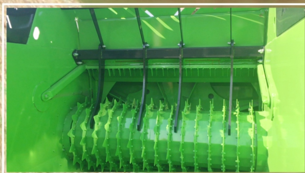
Controcoltello idraulico posizione d'inserto Hydraulic knife switched off
