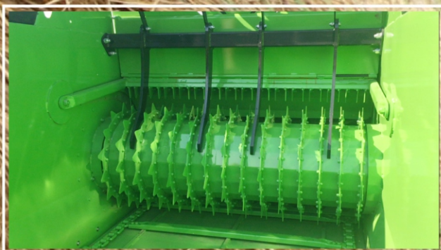
Controcoltello idraulico posizione taglio corto Hydraulic knife cutting short position
