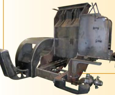
Nahtlose Verbindung des Rahmens mit dem Fräskanal damit ist der Rahmen sehr stabil für höchste Belastbarkeit, ins besonders beim Fräsen gegen eine Silowand.
