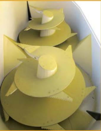
Coclee coniche a due velocità di rotazione (18-38 g/min) con parte superiore inclinata per evitare accumuli di prodotto. Le coclee sono in acciaio ST 52.3 sp. 15 mm e dotate di coltelli BUSATIS con riporto ai carburi di tungsteno.
