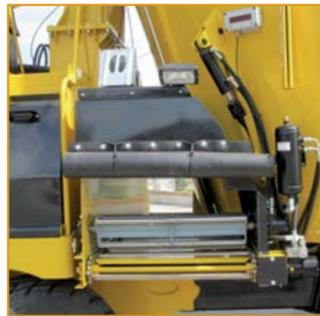
Pesa grafica programmabile (20 ric. x 20 comp.) e celle di carico in inox ad elevata portata (7600 kg./cad.).
