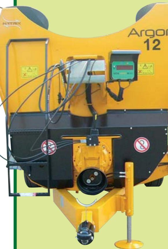
Vista anteriore - La serie ARGON è dotata di serie di scaletta di ispezione ed impianto di pesatura elettronico programmabile con display montato su supporto girevole. A richiesta la macchina può essere allestita con molteplici accessori, tra i quali comandi a distanza a cavo e piedino d'appoggio idraulico.
