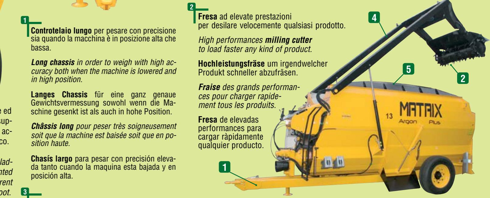
5 Sovrasponde superiori avvitate in acciaio con un profilo speciale per aumentare ulteriormente la capacità di contenimento e per migliorare la miscelazione.
